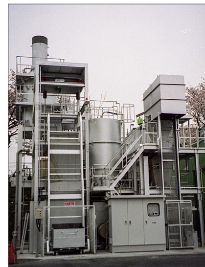
焼 却 物:コーヒー滓、茶殻、戻り乳製品 焼却能力:480kg/Hr
