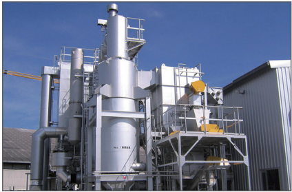
燃 焼 物:畜糞コンポスト 燃焼能力:625kg/Hr
