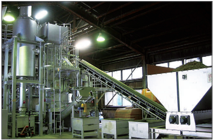
燃 焼 物:ブロイラー鶏糞 燃焼能力:140kg/Hr
