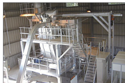
焼 却 物:汚泥、腹糞、敷き藁 焼却能力:195kg/Hr
