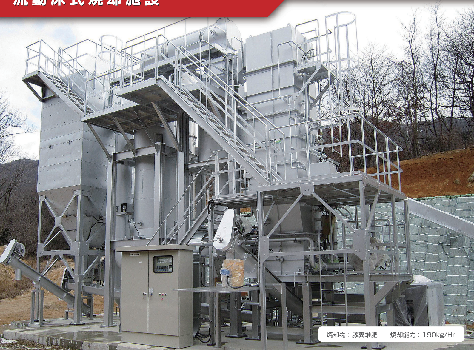
焼 却 物:汚泥、腹糞、敷き藁 焼却能力:195kg/Hr
